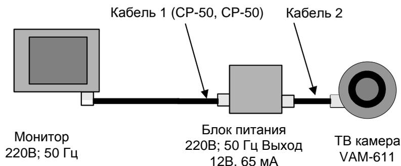
Рис.1. Схема включения камеры VAM-611.
