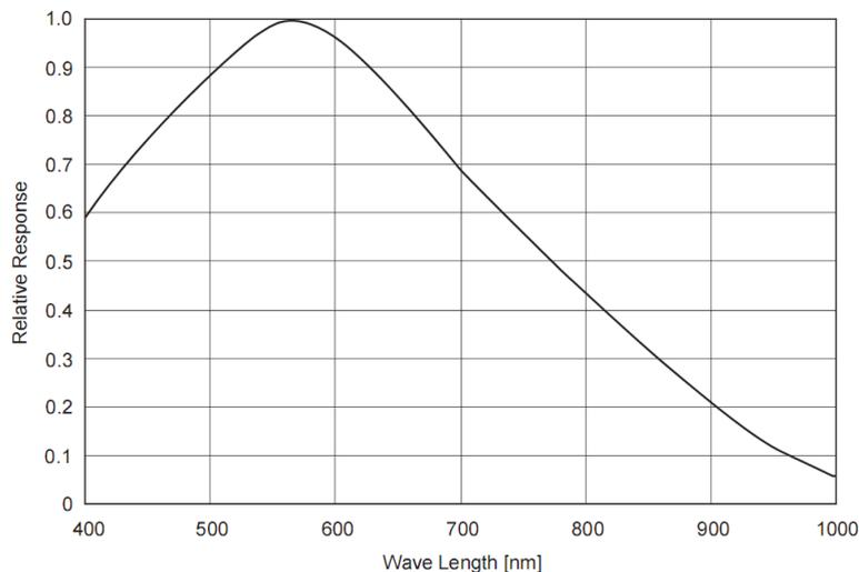
Рис. 3. Спектральная характеристика матрицы ПЗС типа ICX259AL
