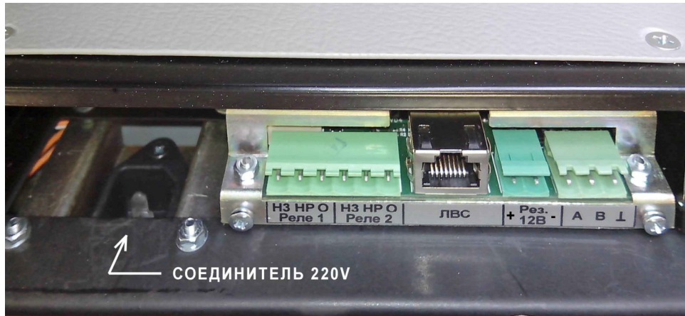
Рис. 3 Расположение соединителей для внешних подключений в нише секции управления
