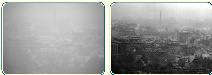
Иллюстрация наблюдения в тумане с плотностью ориентировочно 15 дБ/км камерой WAT-902H (левая) и камерой «ЭВС» VSC-751 (правая). Дистанция до объектов в центральной зоне изображения около 1 км.
