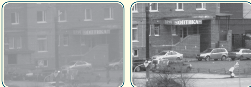
Иллюстрация наблюдения в тумане с плотностью ориентировочно 5 дБ/км камерой WAT-902H (левая) и камерой «ЭВС» VSC-751 (правая). Дистанция до объектов – 1,7 км.
